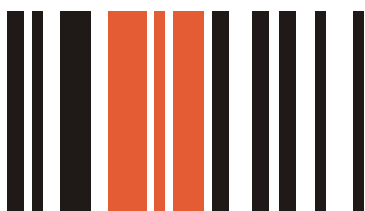
Secțiune mărită a începutului codului GS1-128, având caracterul Funcție 1 marcat cu portocaliu.
